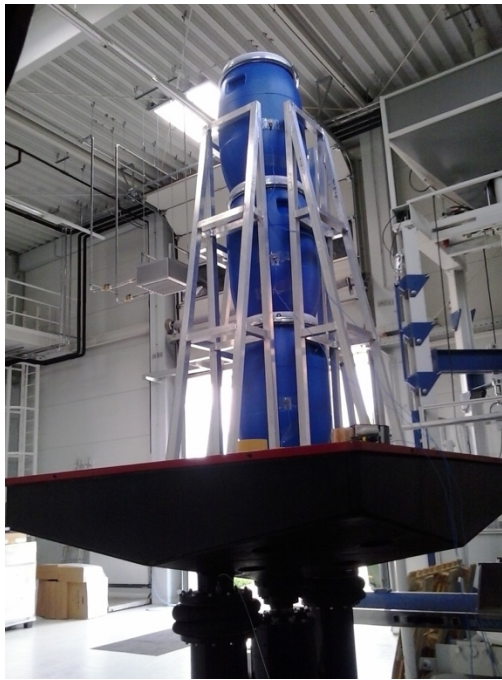
4.2. Ábra. – A halmazolt hordókból összeállított mérési rendszer (Forrás: Saját ábra)
