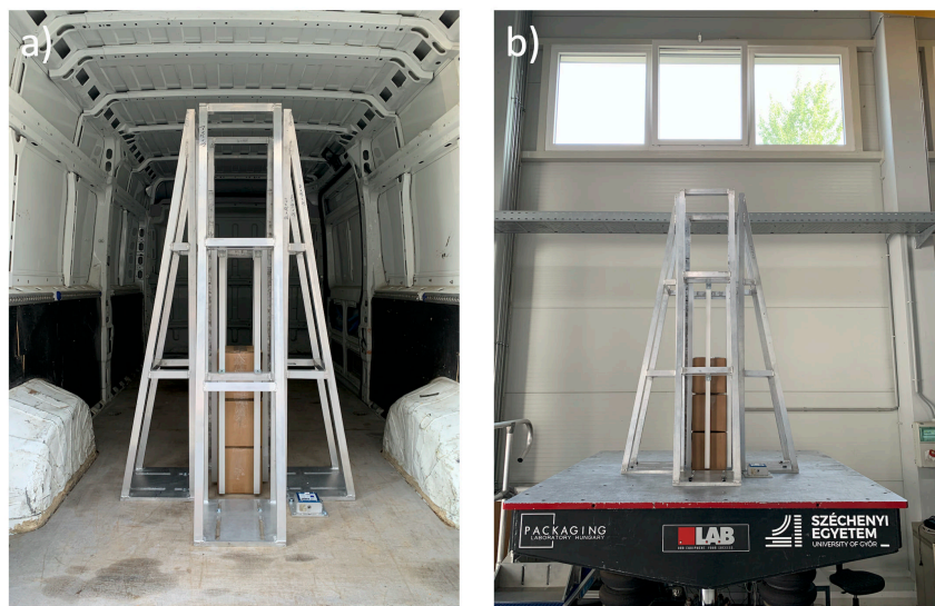
7.2. Ábra – a) A mérőrendszer összeállítása a kistehergépjárműben és b) a laboratóriumban (Forrás: Saját fénykép)
